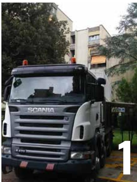
L'impianto arriva in cantiere ed è completamente autonomo. Il massetto è già al suo interno nelle quantità necessarie per eseguire il lavoro. Non servono collegamenti elettrici né trasporti di materiale o attrezzature prima o dopo la posa del massetto.
